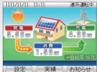
買電/余剰の売電電力(センサーユニット計測値※)を発電量、消費量とともに表示します。
