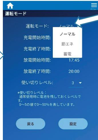
② 運転モードのセレクトボックスをタップして、運転モードを選択します。選択画面をスクロールして選択肢を表示させてください。
