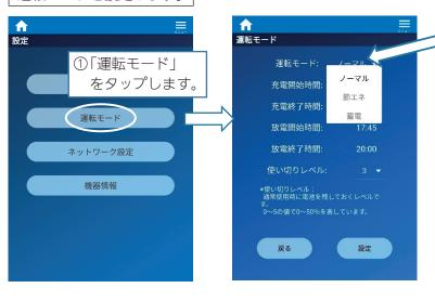
②運転モードのセレクトボックスをタップ して、運転モードを選択します。選択画面をスクロールして選択肢を 表示させてください。
