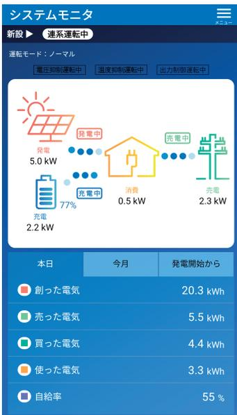
システムの構成機器の動作状態、および電気の流れをグラフィック表示し、システムの運転状態が確認できます。
