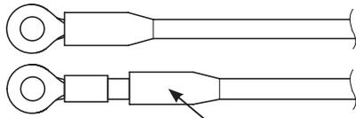
絶縁キャップは、圧着後に圧着端子のカシメ部分が隠れるように、圧着をする前に通しておきます。
