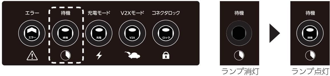
2. コネクタロックランプが点灯している場合、コネクタロックボタンを押し、ロック状態を解除します。
