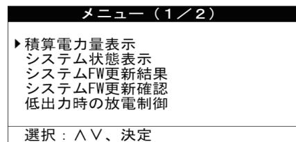
「システムFW更新結果」は更新結果があるとき、「システムFW更新確認」は更新が必要なときに表示されます。
