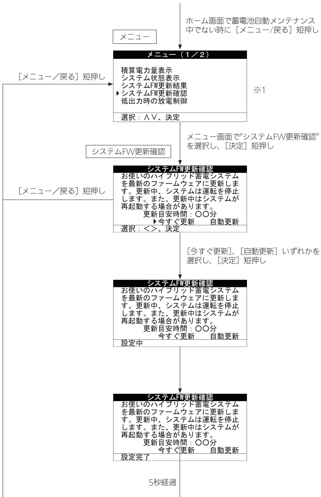
※1 「システムFW更新結果」は更新結果があるとき、「システムFW更新確認」は更新が必要なときに表示されます。
