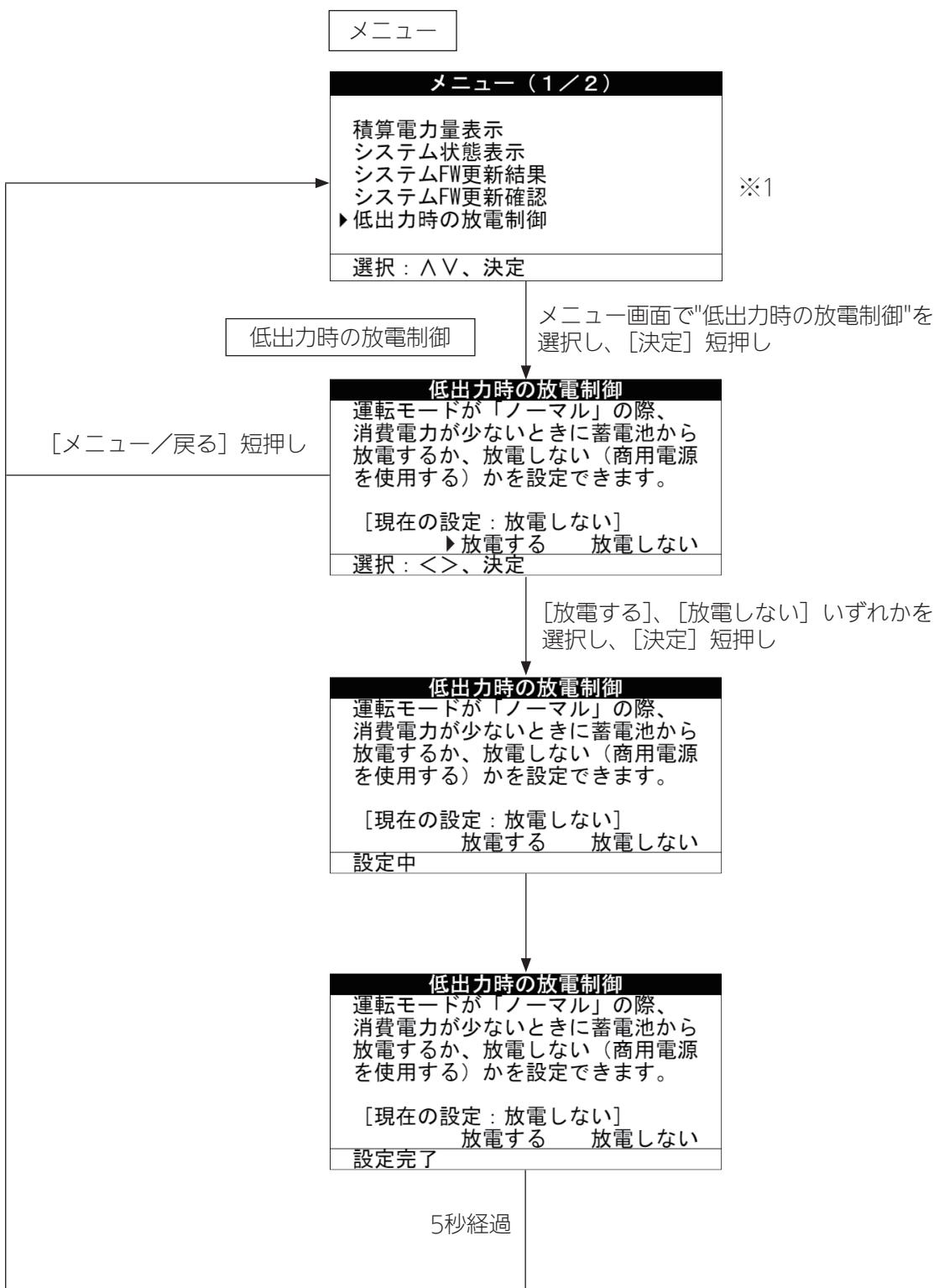
※1 「システムFW更新結果」は更新結果があるとき、「システムFW更新確認」は更新が必要なときに表示されます。
