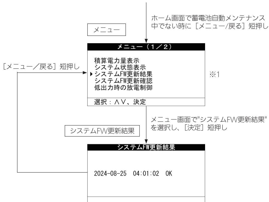
※1 「システムFW更新結果」は更新結果があるとき、「システムFW更新確認」は更新が必要なときに表示されます。
