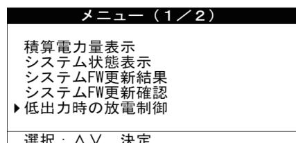
3 低出力時の放電制御画面で [操作 (<>)] ボタンで放電する/しないを選択する。
