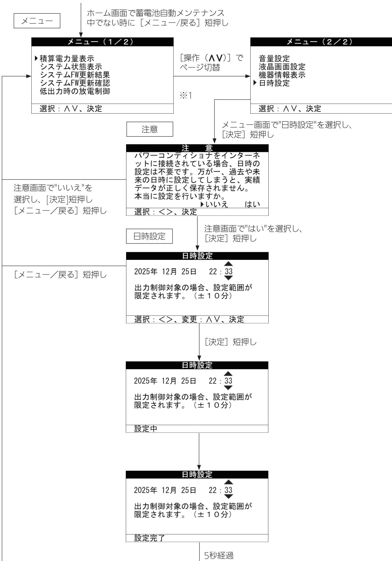
※1 「システムFW更新結果」は更新結果があるとき、「システムFW更新確認」は更新が必要なときに表示されます。
